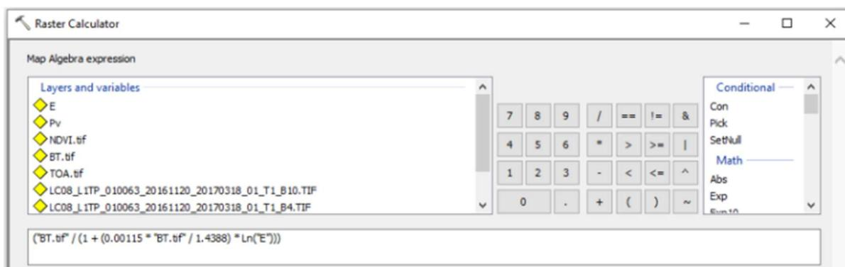
Рисунок 30 – Вычисление температуры поверхности земли
