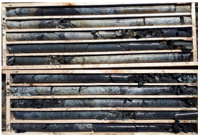
Рисунок 3 – Пример керна, скважина с-180, Чумекское месторождение
